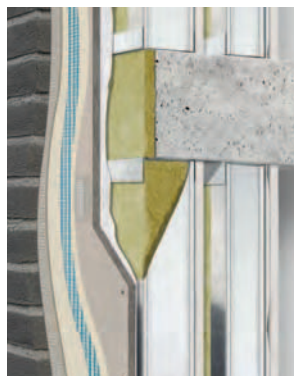
Kettős vázszerkezet impregnált gipszkarton köztes lemezzel
